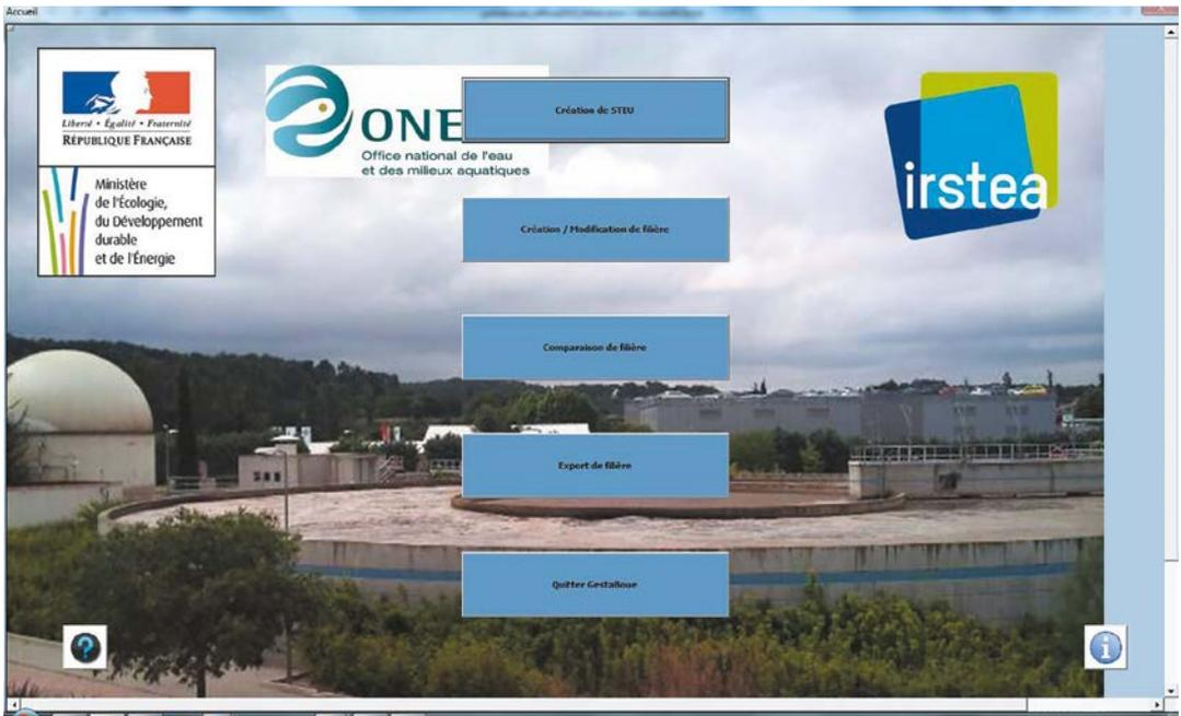
Gestaboues permet de comptabiliser les émissions annuelles de 3 GES ( $\text{CO}_2$ ,  $\text{CH}_4$ ,  $\text{N}_2\text{O}$ ) émis par le traitement des boues d'une station de traitement des eaux usées (STEU) pour chaque étape de la filière, y compris la voie de valorisation des boues. Gestaboues comptabilise les principales émissions générées par les traitements et notamment :
