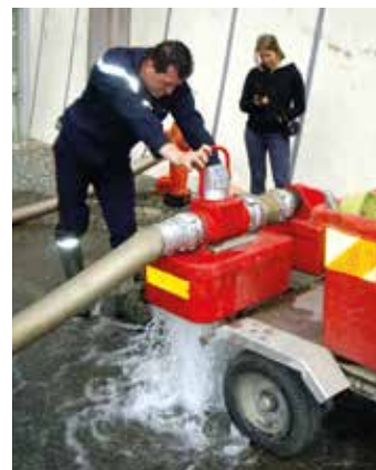
Essai d'un poteau incendie (source : Irstea)
