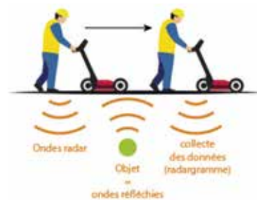
Principe de la géodétection (source : I.D.R.S)
