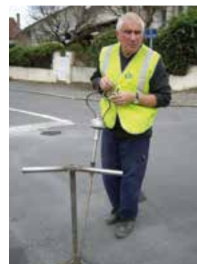
Réalisation d'une écoute directe mécanique (source : Irstea)
