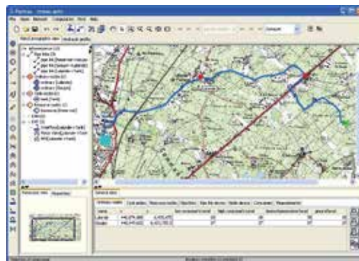
Exemple de modélisation avec le logiciel Porteau (source : Irstea)
