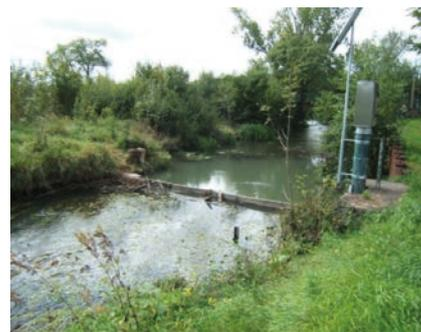
Station limnimétrique avec panneau solaire à l'amont d'un seuil
