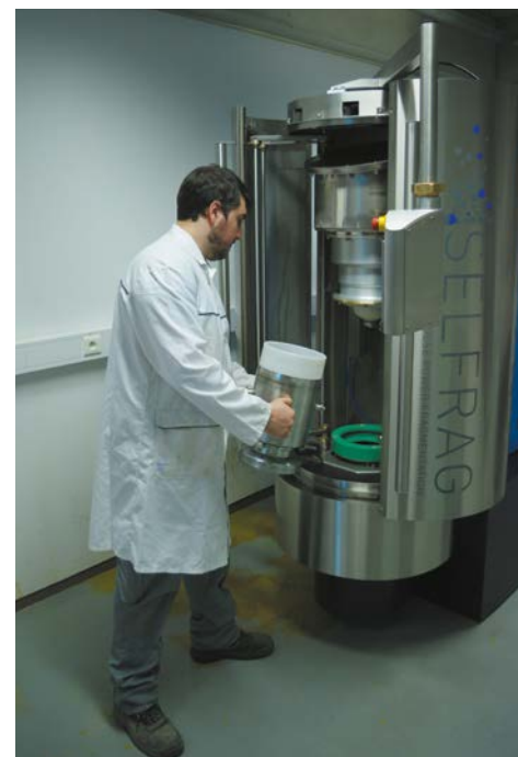
Equipement expérimental de fragmentation électrodynamique acquis par le département GeMME de l'Université de Liège pour favoriser la libération des métaux à des fins de recyclage.
