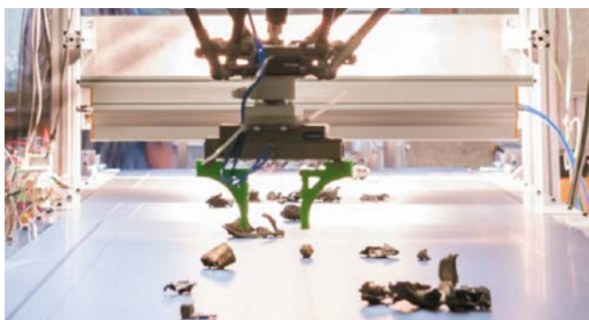
Prototype de tri intelligent des alliages métalliques développé par le département de Génie Minéral, Matériaux et Environnement (GeMME) de l'Université de Liège.
