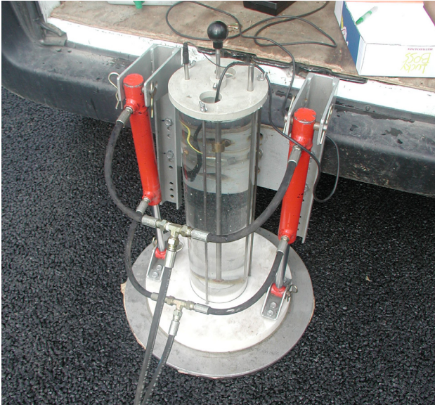
Figure 22 : Drainomètre de chantier. Source : Adopta.
