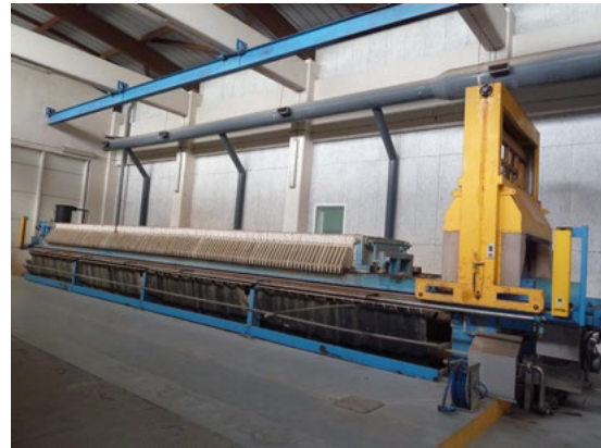
Description d'un filtre-pressé Source : CIRSEE
