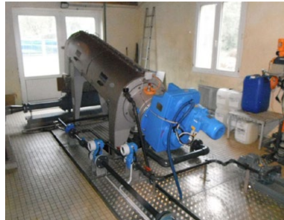
Description d'une presse à vis Source : CIRSEE
